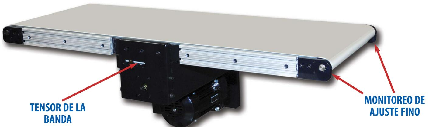
Transportador mostrado con motor ubicado al centro y con rieles de aluminio laterales opcionales, los cuales proveen flexibilidad al montaje.
