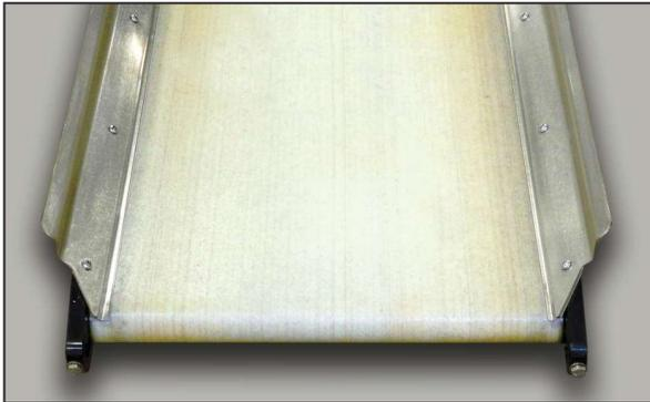
Para evitar que los pequeños fragmentos o residuos se coloquen por debajo de los lados de la cinta, se pueden diseñar guardas especiales de forma que son sujetadas firmemente para proteger los laterales de la banda. Esta opción requiere el uso de una banda sinfín y para transportadores compactos, se debe utilizar una charola de estilo-U.
