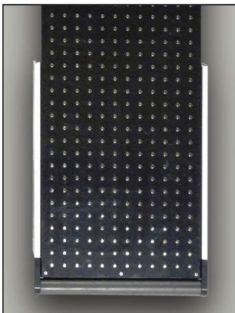
Imanes son incrustados en la banda de desgaste ubicada directamente debajo de la banda. Cuando el transportador está en funcionamiento, la banda viajará a través de los imanes de modo que las partes de acero y residuos serán movidos en dirección a la cinta y en la dirección de los imanes.
