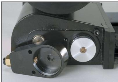
Sensor se utiliza en conjunto con el circuito de protección del troquel para parar la prensa si la banda se ha detenido. Esto evitará o minimizará el daño al troquel y al transportador.
