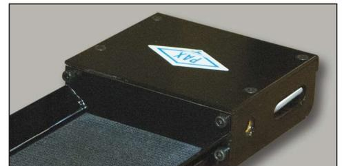
Esta alternativa de tensionado permite que el extremo del transportador descansa directamente sobre la mesa de la prensa (Bolster). Cuando se utiliza esta opción, la dirección de la banda debe ser hacia el motor. Tenga en cuenta que esta opción sólo se puede utilizar con las configuraciones de Motor Invertido, Motor de Angulo Recto, y el Motor Superior Extendido.
